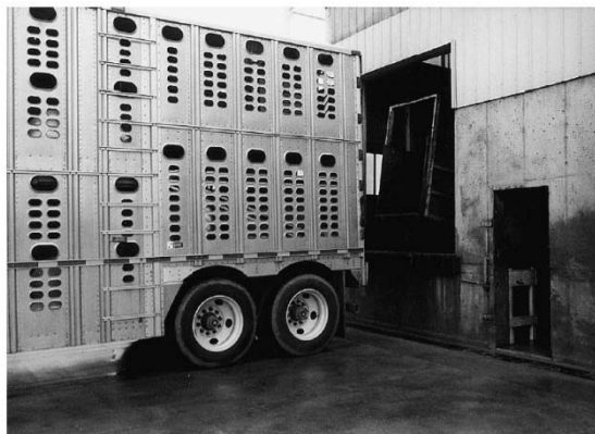
نوعی از تریلرهای حمل احشام با منافذهایی جهت تهویه
